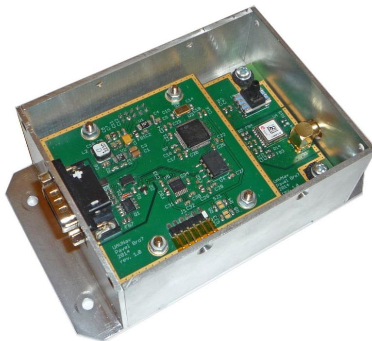
Obr. 23: Pohled dovnitř zrealizované navigační jednotky
